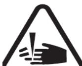
Místa, označená touto značkou, jsou ohrožená provozem šneku. Vkládání rukou do zásobníku paliva v blízkosti šneku, hrozí úrazem a poraněním ruky.
